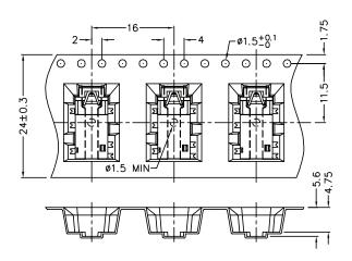
ø381±5 - CARRIER TAPE A: Empty 160 mm min. 05 B: Empty 100 mm min. C: Cover 400 mm min. -LABEL PLASTIC REEL
