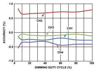
FIGURE 7. ACCURACY vs PWM DIMMING (V<sub>IN</sub>: 24V, V<sub>OUT</sub>: 55V FOR 4P18S, I<sub>CH</sub>: 100mA)
