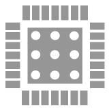
FIGURE 28. ISL97687 TQFN PCB VIA PATTERN
