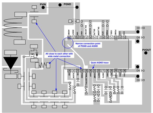
FIGURE 30. EXAMPLE OF ONE LAYER PCB LAYOUT
