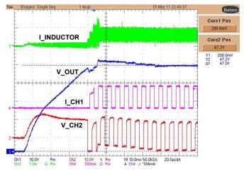
FIGURE 13. START-UP WITH PHASE SHIFT (V  $_{\rm IN}$  : 19V, I  $_{\rm CH}$ : 120mA, LEDs: 4P18S, f  $_{\rm DIM}$ : 200Hz)
