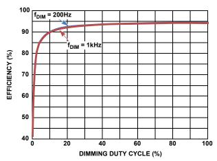
FIGURE 6. EFFICIENCY vs PWM DIMMING (V<sub>IN</sub>: 24V, V<sub>OUT</sub>: 55V FOR 4P18S, I<sub>CH</sub>: 100mA)
