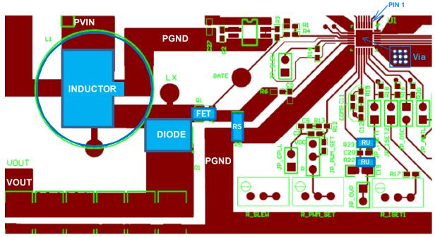
FIGURE 29. EXAMPLE OF TWO LAYER PCB LAYOUT
