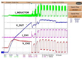
FIGURE 12. START-UP WITHOUT PHASE SHIFT (V  $_{\rm IN}$  : 19V, I  $_{\rm CH}$  : 120mA, LEDs: 4P18S, f  $_{\rm DIM}$  : 200Hz)
