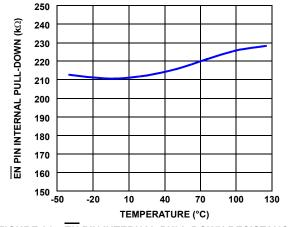
FIGURE 21. EN PIN INTERNAL PULL-DOWN RESISTANCE
