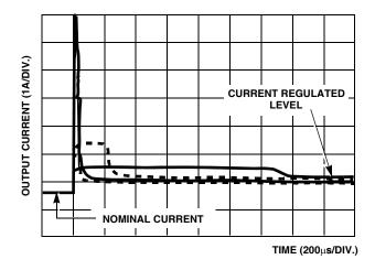
FIGURE 6. OC TO CR SETTLING TIME WAVEFORMS
