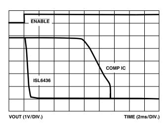
FIGURE 17. COMPARATIVE TURN-OFF WAVEFORMS
