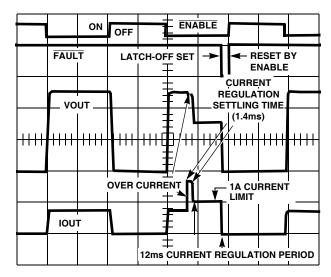
FIGURE 1. TYPICAL OPERATIONAL WAVEFORMS
