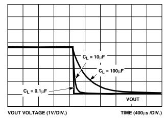
FIGURE 9. FAST TURN-OFF vs  $C_{\mathsf{LOAD}}$
