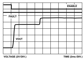
FIGURE 11. ISL6436L TURN-ON INTO 1.5A MOMENTARY OC
