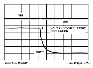
FIGURE 18. SWITCH FAULT INDEPENDENCE
