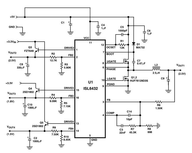
FIGURE 8. POWER SUPPLY APPLICATION CIRCUIT FOR A MICROPROCESSOR COMPUTER SYSTEM
