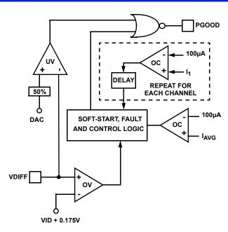
FIGURE 12. POWER GOOD AND PROTECTION CIRCUITRY
