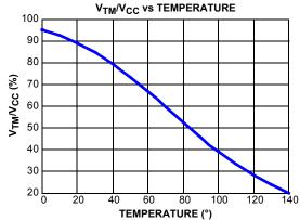
FIGURE 15. THE RATIO OF TM VOLTAGE TO NTC
