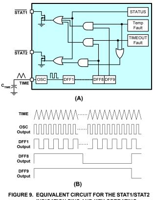
INDICATION PINS AND KEY OPERATING WAVEFORMS
