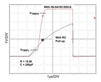
FIGURE 8. ISL54103 DDC SYSTEM BOOST PULL-UP COMPARED TO RESISTOR PULL-UP (V<sub>DD</sub> = 5.5V)
