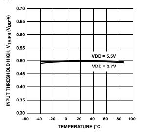
FIGURE 5. V<sub>TRIPH</sub> VOLTAGE
