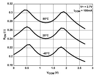
FIGURE 10. ON RESISTANCE vs SWITCH VOLTAGE
