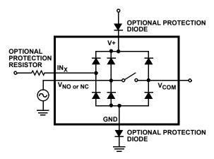
FIGURE 8. OVERVOLTAGE PROTECTION
