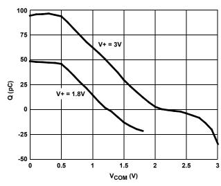
FIGURE 12. CHARGE INJECTION vs SWITCH VOLTAGE
