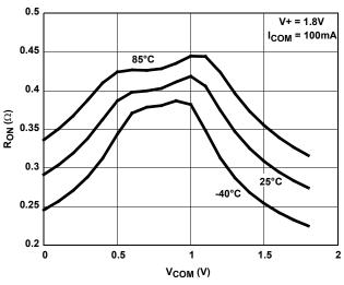
FIGURE 11. ON RESISTANCE vs SWITCH VOLTAGE
