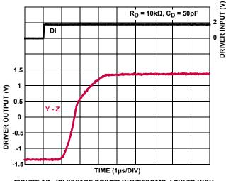
FIGURE 12. ISL32613E DRIVER WAVEFORMS, LOW-TO-HIGH
