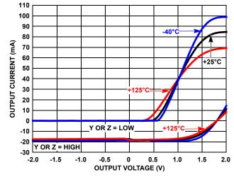
FIGURE 11. DRIVER OUTPUT CURRENT vs SHORT-CIRCUIT VOLTAGE
