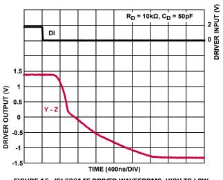
FIGURE 15. ISL32614E DRIVER WAVEFORMS, HIGH-TO-LOW
