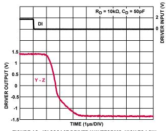
FIGURE 13. ISL32614E DRIVER WAVEFORMS, HIGH-TO-LOW
