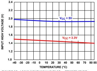
FIGURE 25. LOGIC INPUT HIGH VOLTAGE VS TEMPERATURE
