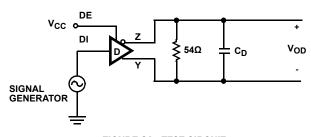
FIGURE 6A. TEST CIRCUIT
