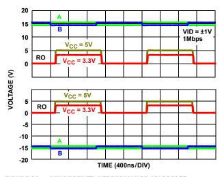
FIGURE 20. ±15V RECEIVER PERFORMANCE (ISL32433E, ISL32435E)
