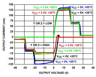
FIGURE 14. DRIVER OUTPUT CURRENT vs SHORT CIRCUIT VOLTAGE
