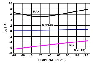
FIGURE 28. I<sub>OS</sub> vs TEMPERATURE V<sub>+</sub>, V<sub>-</sub> = ±2.5V
