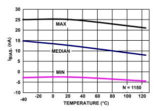
FIGURE 25. I<sub>BIAS</sub>- vs TEMPERATURE, V<sub>+</sub>, V<sub>-</sub> = ±2.5V
