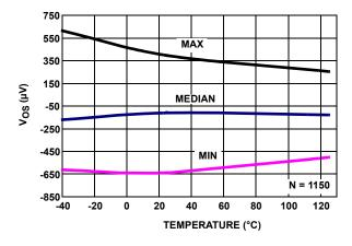
FIGURE 22.  $V_{OS}$  (SOT PKG) vs TEMPERATURE,  $V_+$ ,  $V_-$  = ±2.5V
