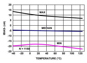
FIGURE 27.  $I_{BIAS}$  vs TEMPERATURE,  $V_+$ ,  $V_- = \pm 1.2V$
