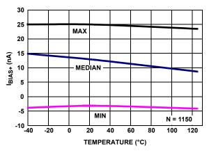
FIGURE 24.  $I_{BIAS+}$  vs TEMPERATURE,  $V_+$ ,  $V_- = \pm 2.5V$
