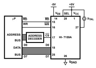
FIGURE 3. PARALLEL MODE CONFIGURATION
