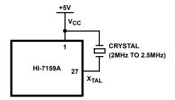
FIGURE 7. SINGLE-PIN OSCILLATOR
