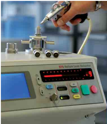
Vacuumtest with leakdetector Vakuumtest mit Leakdetektor
