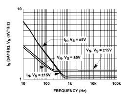
FIGURE 26. NOISE vs FREQUENCY
