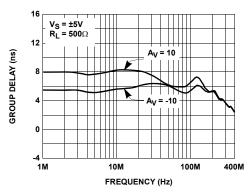
FIGURE 28. GROUP DELAY vs FREQUENCY
