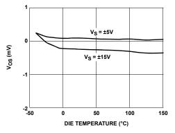
FIGURE 35. OFFSET VOLTAGE vs TEMPERATURE
