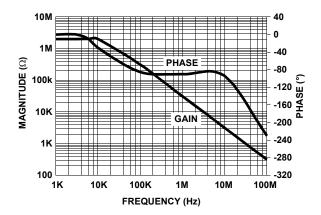
FIGURE 35. TRANSIMPEDANCE (ROL) vs FREQUENCY
