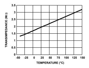
FIGURE 48. TRANSIMPEDANCE vs TEMPERATURE
