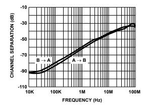
FIGURE 33. CHANNEL SEPARATION vs FREQUENCY (ALL POWER LEVELS)
