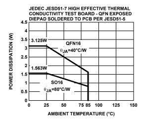
FIGURE 50. PACKAGE POWER DISSIPATION vs AMBIENT TEMPERATURE
