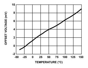
FIGURE 47. OFFSET VOLTAGE vs TEMPERATURE
