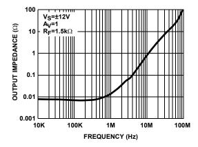
FIGURE 32. OUTPUT IMPEDANCE vs FREQUENCY (ALL POWER LEVELS)
