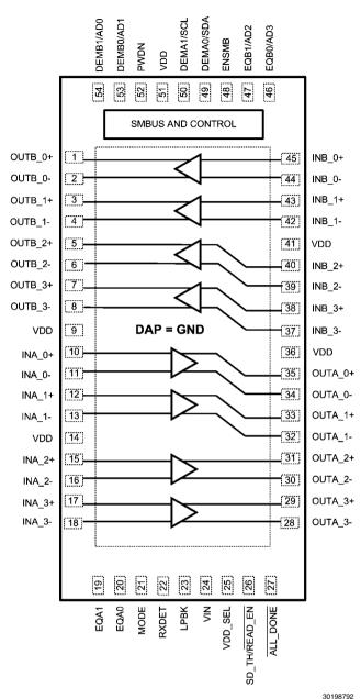
DS125BR401 Pin Diagram 54-lead QFN
