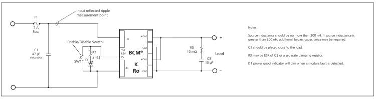
Figure 20 — BCM<sup>®</sup> module test circuit
