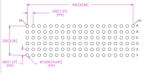
RECOMMENDED STENCIL LAYOUT STENCIL TO BE .0060[0.152] THICK
