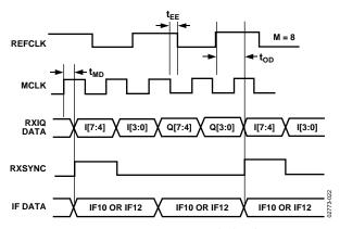
Figure 22. Rx Port Timing (Nonmultiplexed Data)
